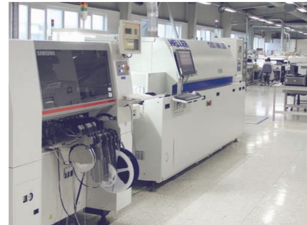
Ligne de production SMD
