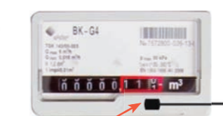
Aimant intégré dans le compteur de gaz
