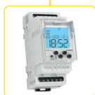
TER-9 2 teplotní vstupy, 2 výstupy 8 A přepínací, 6 funkcí, vestavěné spínací hodiny, podsvětlený LCD, galvanicky odd. napájení AC 230 V nebo AC/DC 24 V, 2 MODUL. Teplotní rozsah: -40 .. +110 °C. str. 141
