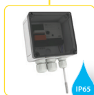
TEV-2 Termostat pro regulaci vytápění (chlazení), nastavitelný rozsah -20 .. +20 °C, externí senzor NTC, výstupní kontakt 16 A přep. str. 144
